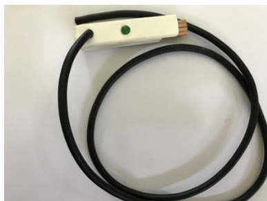
FIGURE .5. CIRCUIT DE CONDITIONNEMENT DU CAPTEUR DE COURANT ET SON IMAGE
