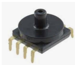
FIGURE .7. IMAGE ET CIRCUIT DE CONDITIONNEMENT DU CAPTEUR DE PRESSION MPXV5004AP
